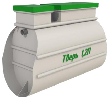
Автономное очистное сооружение «Тверь - 1,2П» хорошо подходит для обслуживания 5-7 человек. Она изготавливается из высокотехнологичного материала – полипропилена. Это способствует невысокой цене и отличному качеству очистного сооружения. Рабочий объем установки – 1200 литров воды в сутки (принятый средний расход – 200 литров воды на человека в день). При этом она может выдержать залповый сброс воды с обычной бытовой ванны. Глубина подводящего патрубка для установки принимается 0,3м от уровня
